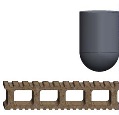
Abbildung 4: Beispiel für die Kugelfall-Prüfung in der Längskante, Kugelaußenseite bündig mit Profilrand
